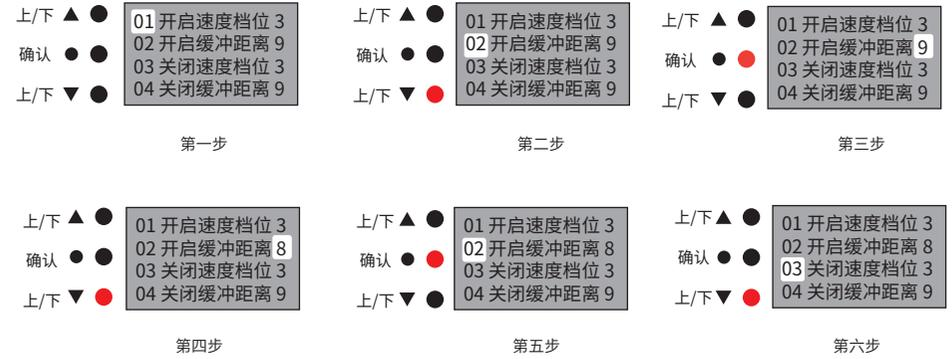
开门机控制器的参数在出厂时通常已经调整为较合适的状态,通常不需要用户调整参数。当用户确需调整参数,可以通过按键配合液晶屏来设置参数。为了环保节能,开门机控制上液晶屏通常是息屏状态。
