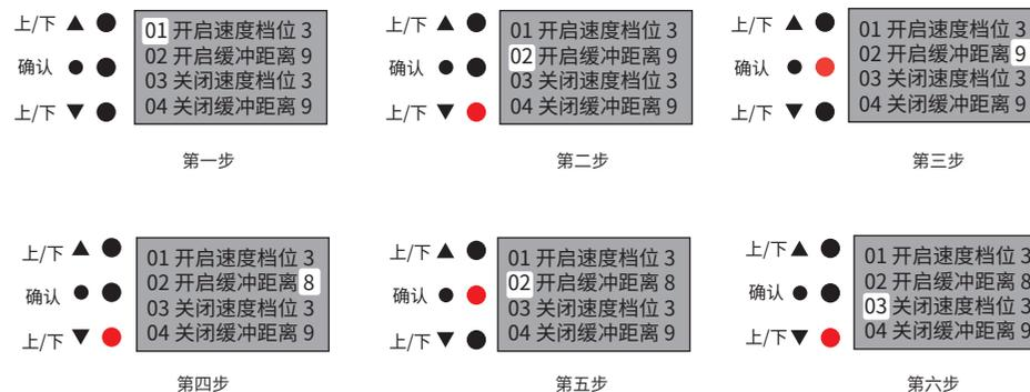
开门机控制器的参数在出厂时通常已经调整为较合适的状态,通常不需要用户调整参数.当用户确需调整参数,可以通过按键配合液晶屏来设置参数.为了环保节能,开门机控制上液晶屏通常是息屏状态.
